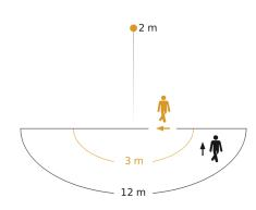
Possibile altezza di montaggio: 1,80 m - 4,00 m
